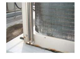
左記は、千葉県大型ショッピングモールで水道水を散水した結果、水道水を殺菌する為に添酸(される次亜塩素酸(ではからによってアルミフィンが腐食した状況です。アルミフィンが部分にぼろになっています。
